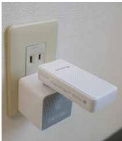
通信ドングルを折って設置
