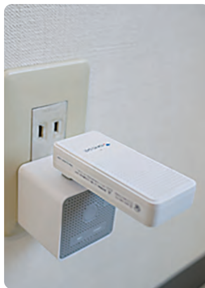
通信ドングルを折って設置
