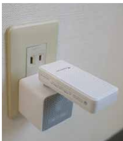
通信ドングルを折って設置
