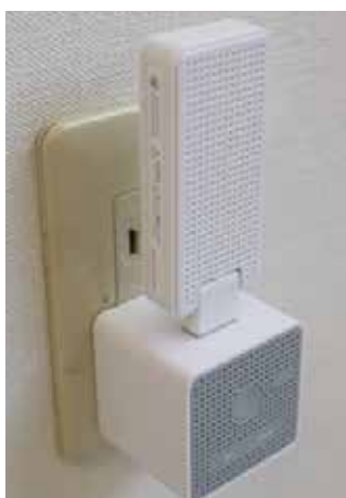
通信ドングルを立てて設置
